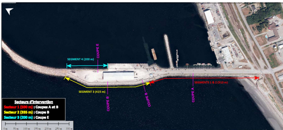
Figure 2-1 : Segments du brise-lames ouest visés par une réfection complète (tirée de Lasalle | NHC, 2024)
