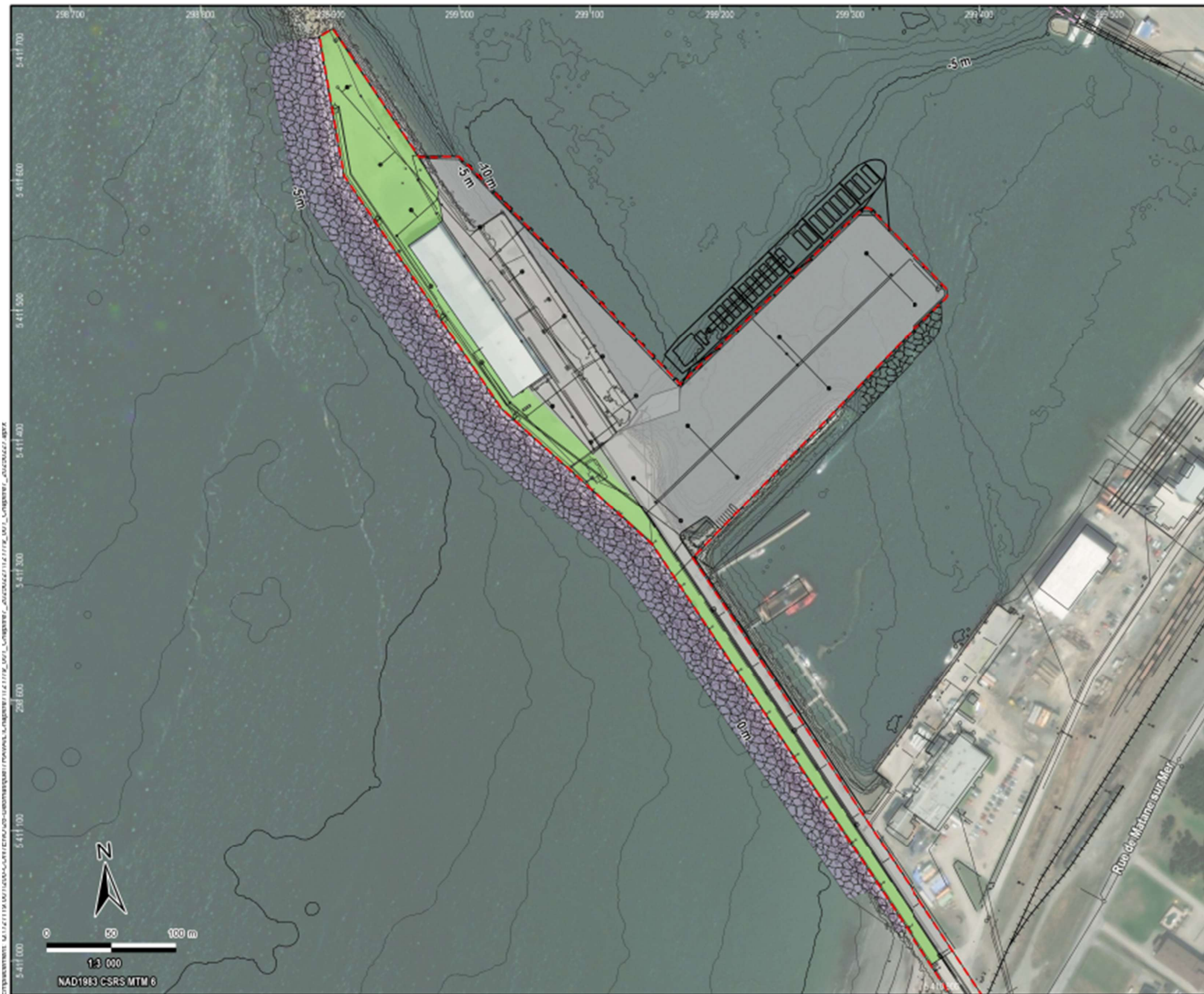
Carte 2-7 : Représentation de la phase 5 (Aménagement des aires de manutention et d'entreposage et rehaussement du brise-lames ouest)
