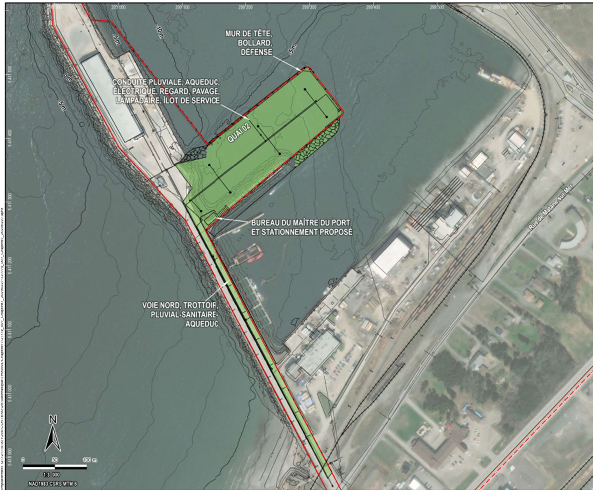
Carte 2-5 : Représentation de la phase 3 (Construction du poste à quai n° 2 et installation des systèmes de service)
