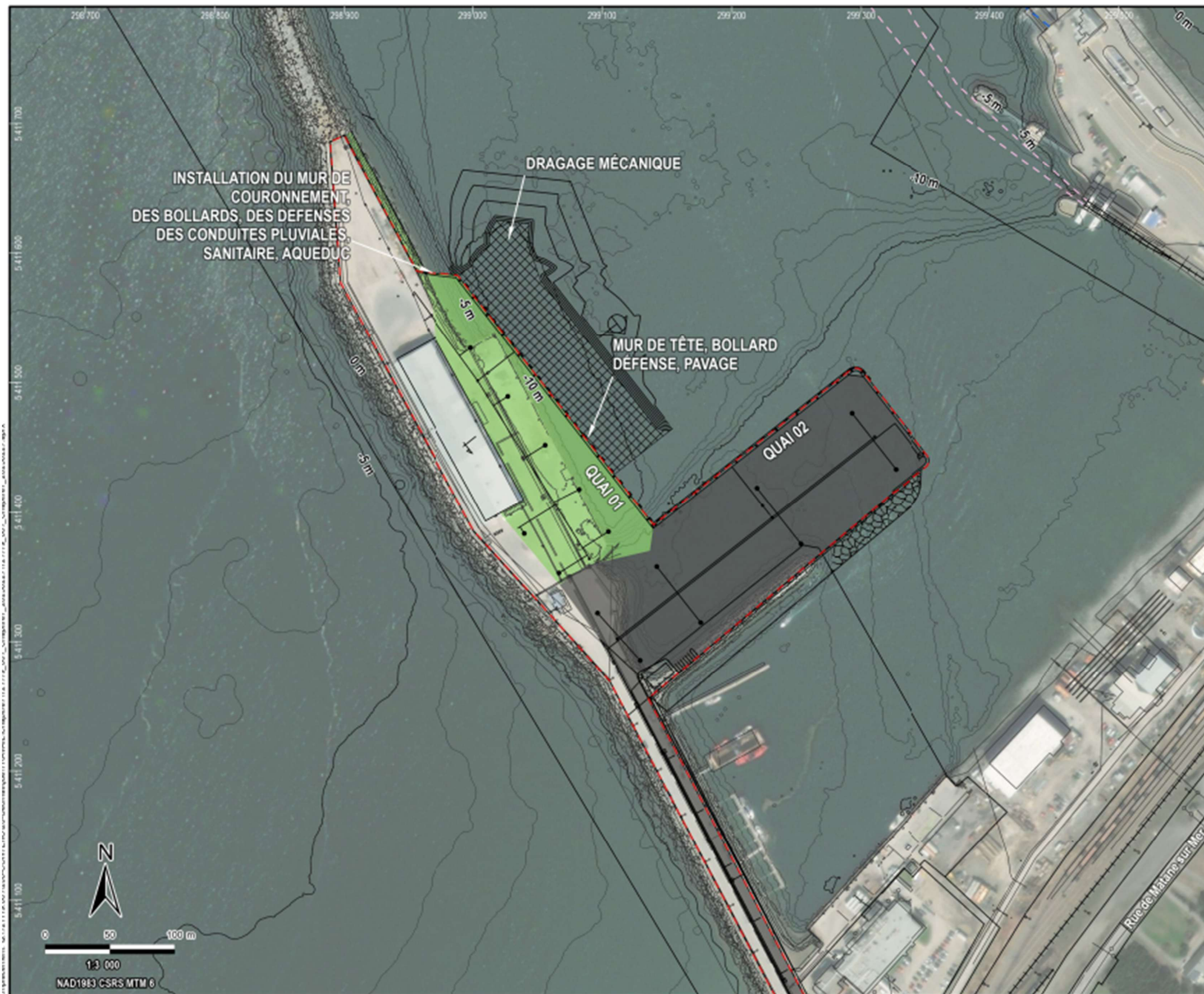
Carte 2-6 : Représentation de la phase 4 (Dragage mécanique, démolition et reconstruction du poste à quai n ° 1)
