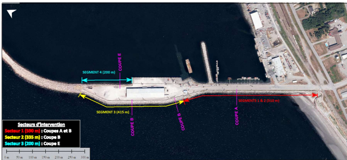
Figure 2-6 : Segments du brise-lames ouest visés par une réfection complète (tirée de Lasalle | NHC, 2024)
