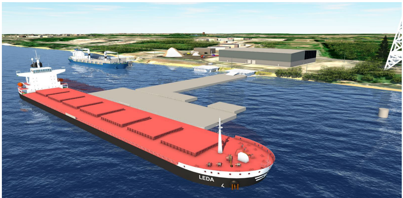
Figure 9-1 : Dessin conceptuel du nouveau quai flottant sur pieux
