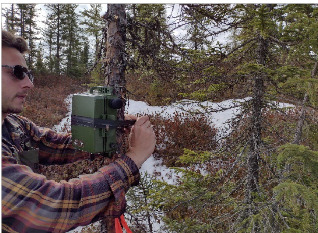
Photo 11. Installation d'un sonomètre
