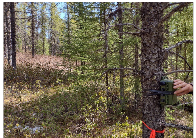
Photo 12. Installation d'un sonomètre
