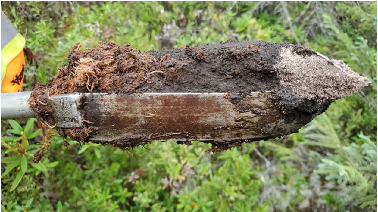
Photo 14 Sols récupérés à l'aide de la tarière manuelle au sondage 20-SM30-350-1.
