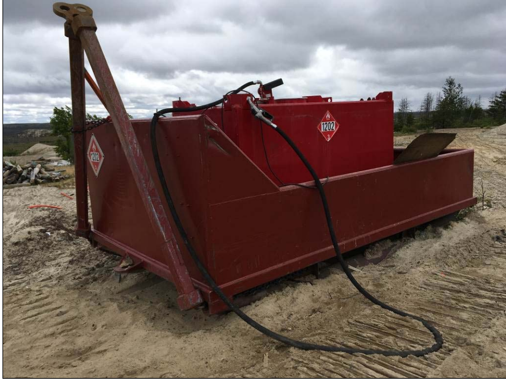
Photo E-5 : Poste de distribution de carburant mobile (poste d'utilisateurs)
