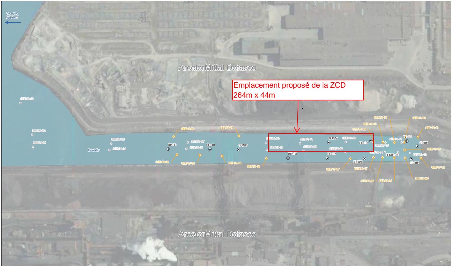
Figure 3 Emplacement et dimension de la ZCD proposé Projet d'assainissement des sédiments du poste de mouillage d'Arcelor Mittal Dofasco Hamilton, Ontario
