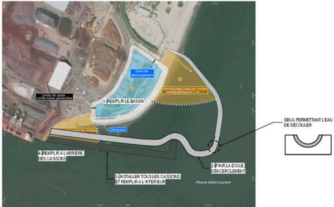
Figure 8 --Séquence de construction des ouvrages de confinement
