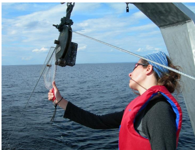
Figure 4. Prise de l'angle du câble par rapport à l'horizon (photographie : Laboratoire des sciences aquatiques de l'Université du Québec à Chicoutimi)
