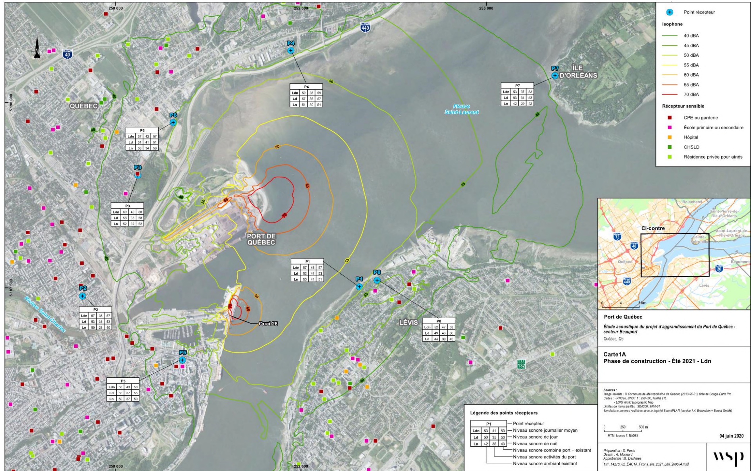
Figure 3-1 Phase de construction – Été 2021 – L dn (tirée de WSP, 2020)
