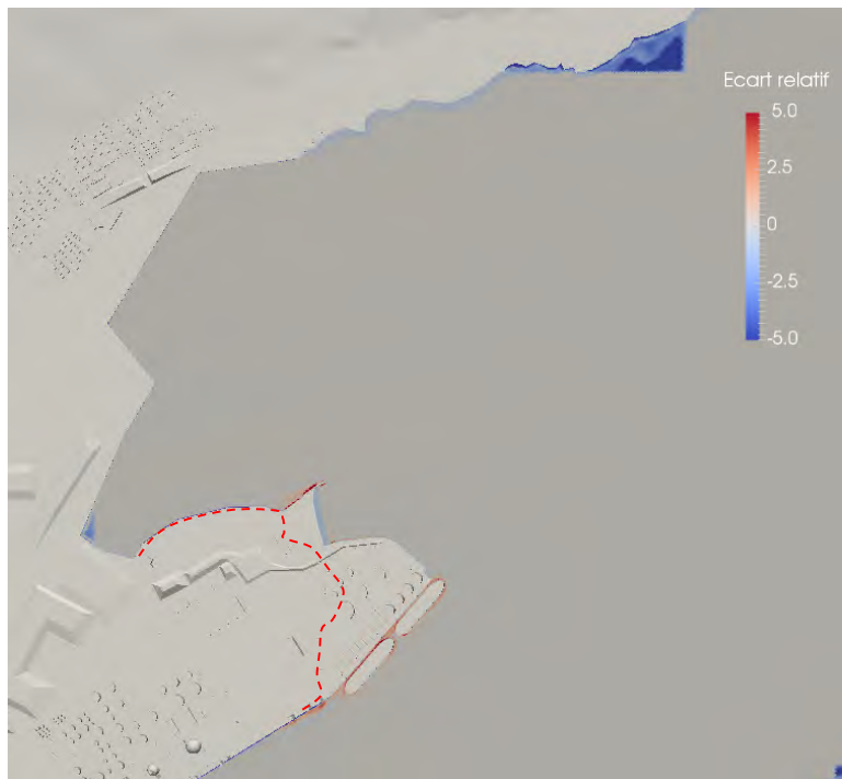
b1) Écart relatif de l'intensité turbulente – 1,4 m au-dessus du niveau de la pleine mer supérieure de marée moyenne
