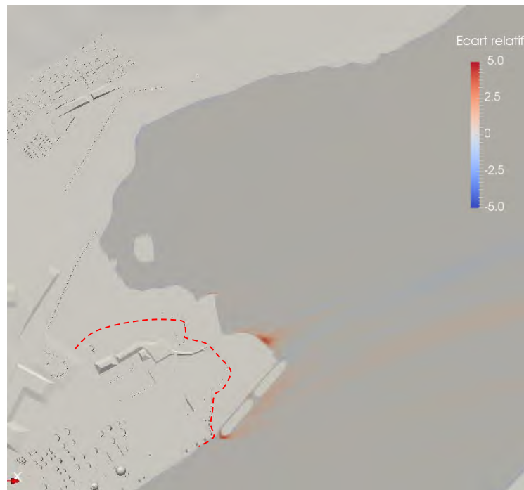
b1) Écart relatif de l'intensité turbulente – 1,4 m au-dessus du niveau de basse mer inférieure de marée moyenne
