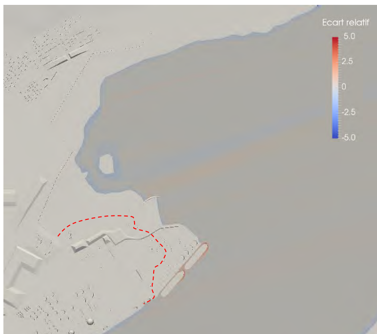
b1) Écart relatif de l'intensité turbulente – 1,4 m au-dessus du niveau de basse mer inférieure de marée moyenne
