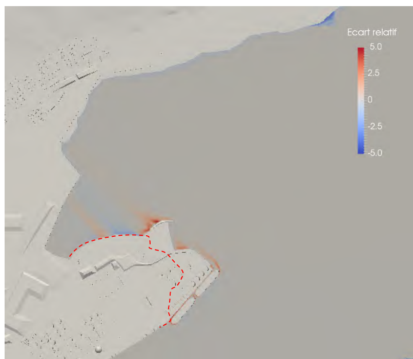
b1) Écart relatif de l'intensité turbulente – 1,4 m au-dessus du niveau moyen de marée
