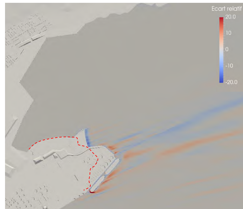
b2) Écart relatif de l'intensité turbulente – 4,4 m au-dessus du niveau moyen de marée
