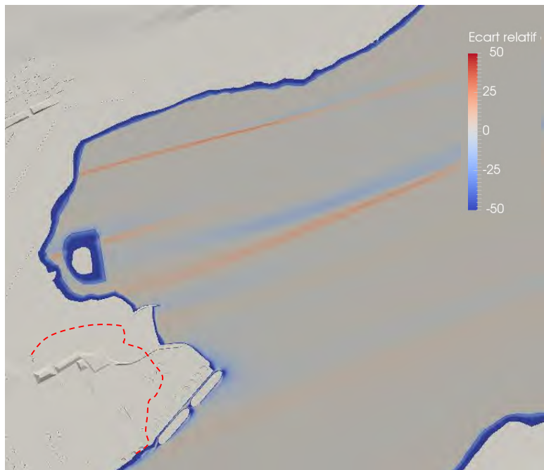
a1) Écart relatif de la vitesse – 1,4 m au-dessus du niveau de basse mer inférieure de marée moyenne
