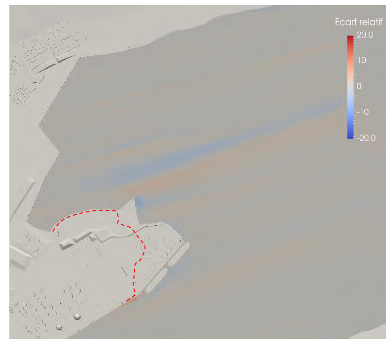
b2) Écart relatif de l'intensité turbulente – 4,4 m au-dessus du niveau de basse mer inférieure de marée moyenne
