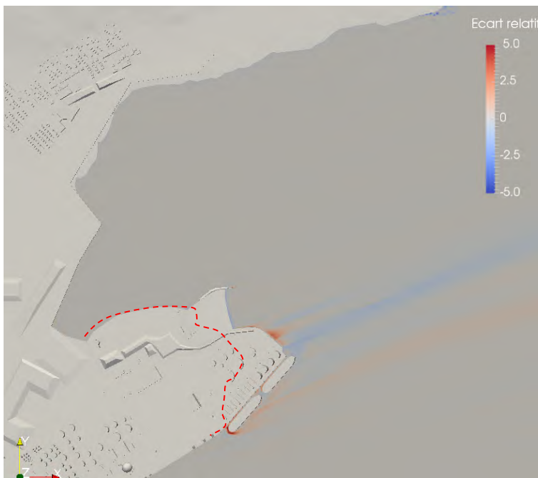
b1) Écart relatif de l'intensité turbulente – 1,4 m au-dessus du niveau moyen de marée
