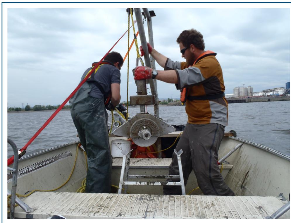
PHOTO 17 — Mise en place de la benne Shipeck pour l'échantillonnage du benthos
