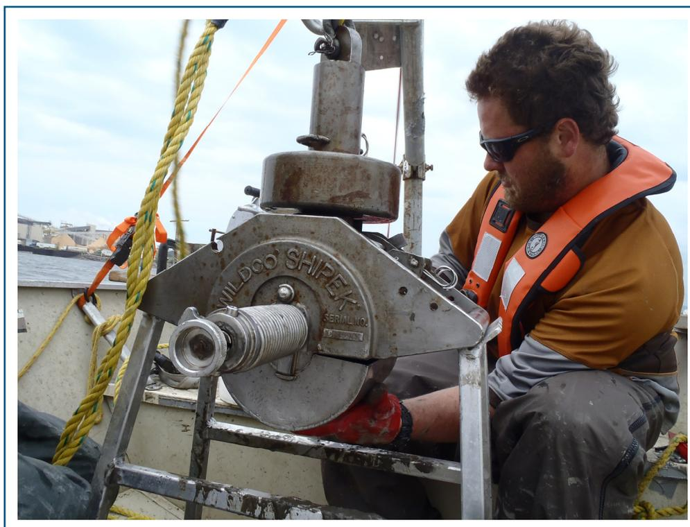
PHOTO 18 — Réception de la benne avec l'échantillon de substrat
