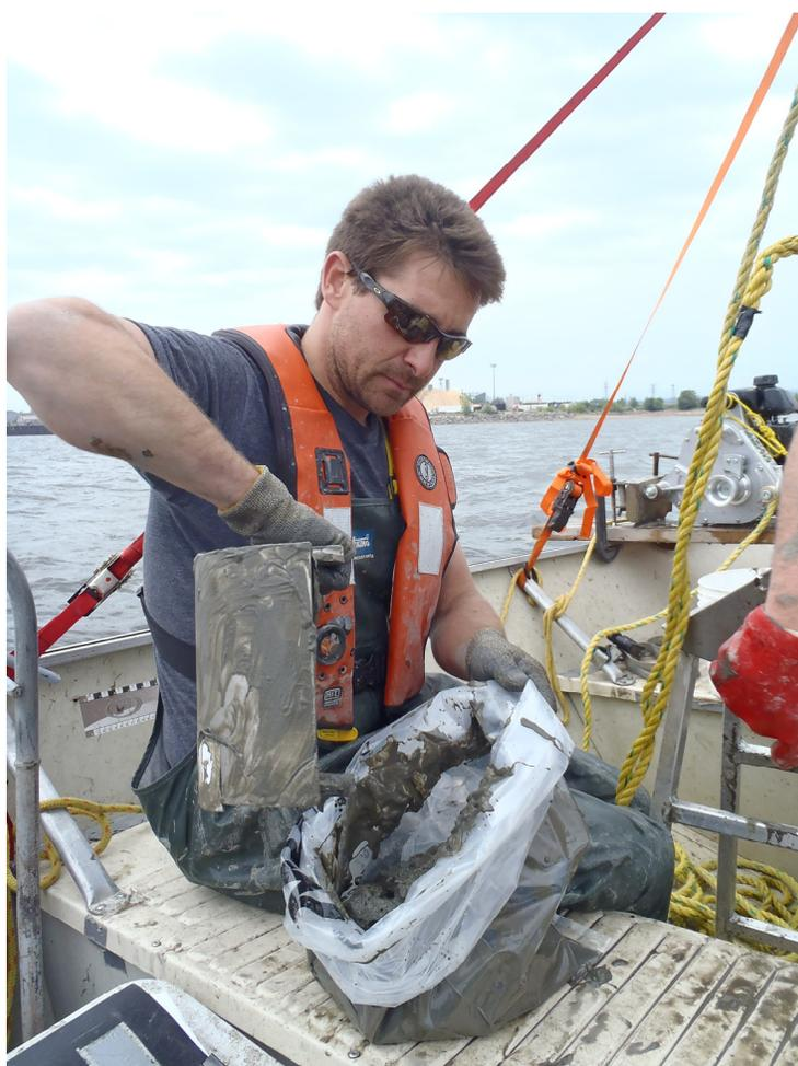
PHOTO 19 — Extraction de l'échantillon du godet de la benne
