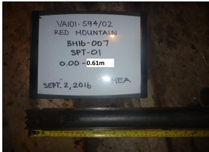
PHOTO 26 BH16-007 SPT-01 0.00-0.61m
