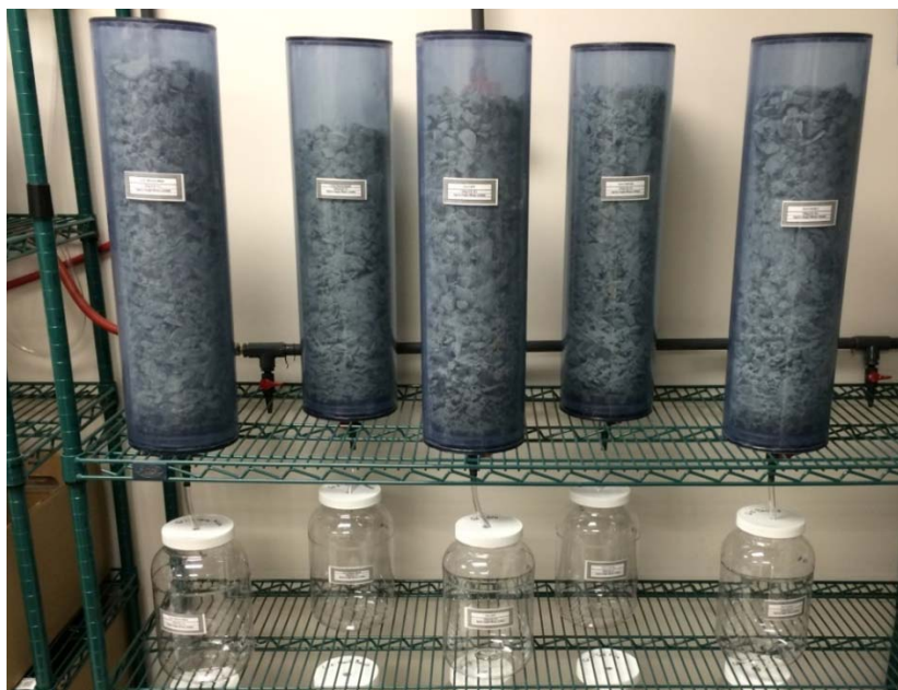
Photo 1 : Colonnes de lixiviation, matériaux Akasaba
