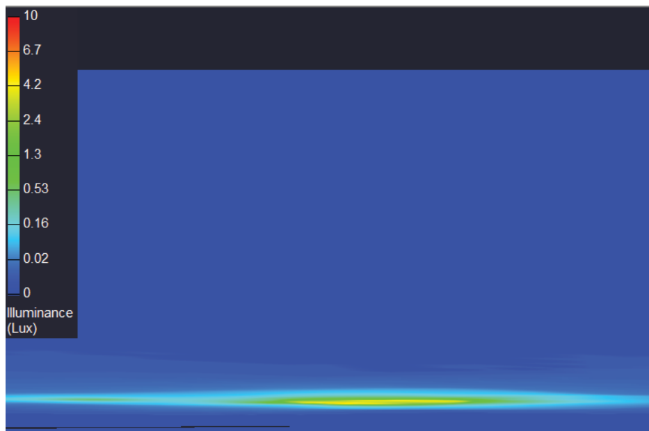
Figure 7 Charte de couleur montrant les niveaux d'éclairage des futures installations à partir du secteur des chalets du lac Bayeul à 100 m au-dessus du sol en hiver
