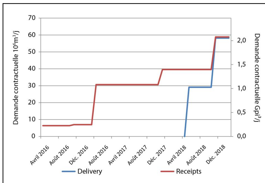
Figure 4-4 : Profil des contrats de réception et de livraison pour la canalisation principale North Montney
