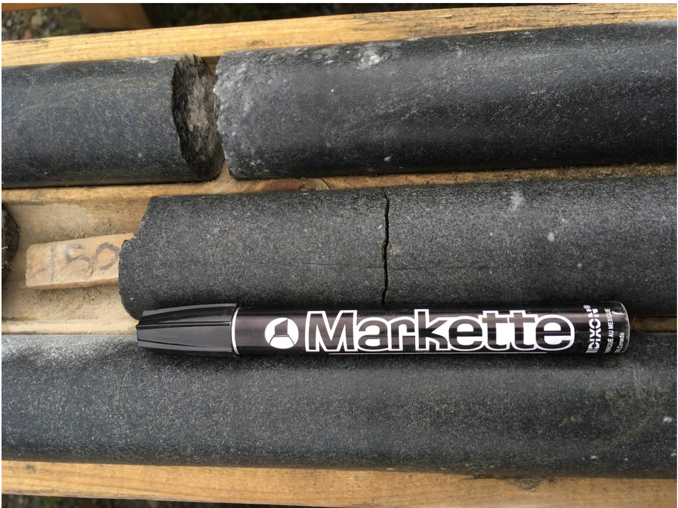
Figure 12 Méta-sédiment décrit comme grès arkosique (forage LR-11-151 @ 150m)
