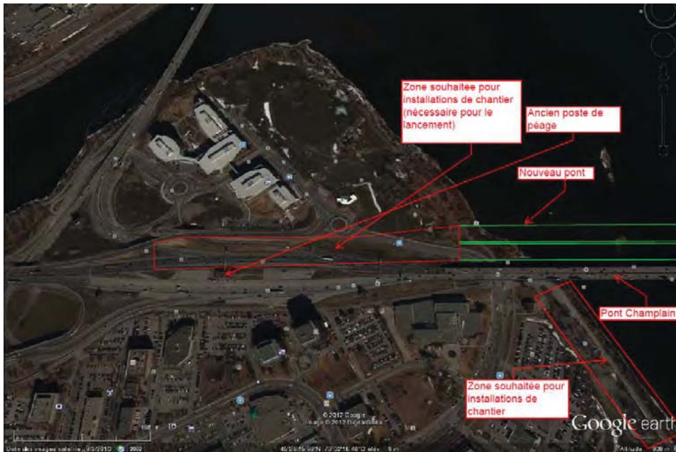
Figure 3 Installation de chantier – Île-des-Sœurs
