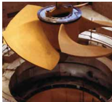
Les turbines de la centrale de Keeyask sont conçues pour minimiser les blessures et la mortalité des poissons.
